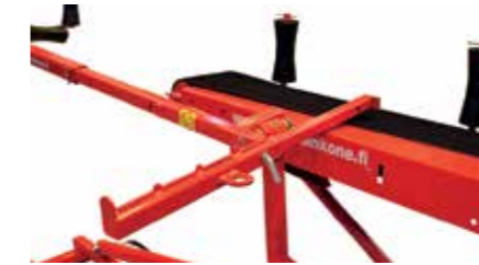
Suportul de transport se scoate din braț și se trece peste transportorul de alimentare.
