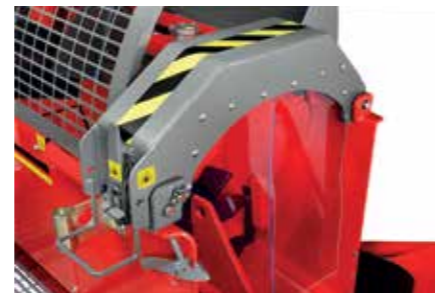
Suportul superior echipat cu un mecanism rapid de blocare face structura utilajului semnificativ mai rezistentă.
