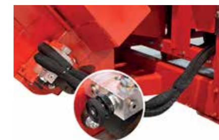
Reglarea vitezei de evacuare a transportorului se realizează printr-supapă, ce poate fi ușor de instalată.
