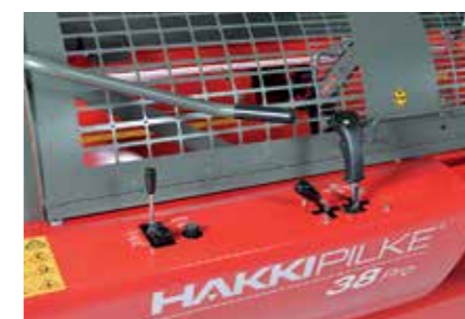
Panoul de comandă ergonomic și ușor de utilizat include toate comenzile necesare pentru funcționarea mașinii.
