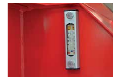
Capacitate mare a rezervorului de ulei și vizor.
